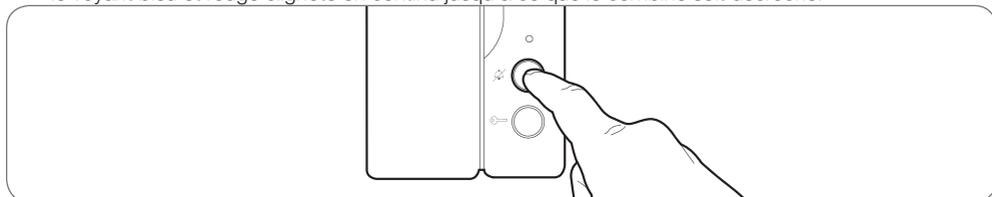
**Attention :** Ne pas appuyer trop longtemps sur le bouton de commande de gâche pour éviter la détérioration de la platine de rue.
