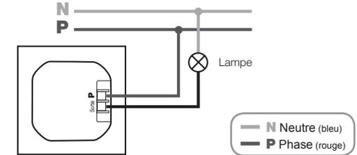
Connectez l'interrupteur comme ci-dessus puis installez-le dans le boîtier d'encastrement.
