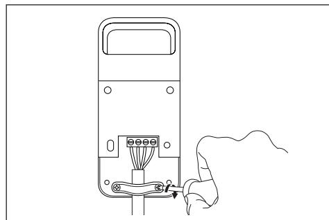
Une fois le raccordement électrique effectué, remettez en place le cache plastique arrière et fixez le récepteur au mur à l'aide des chevilles et vis fournies. Les fixations fournies conviennent uniquement aux murs en maçonneries.
