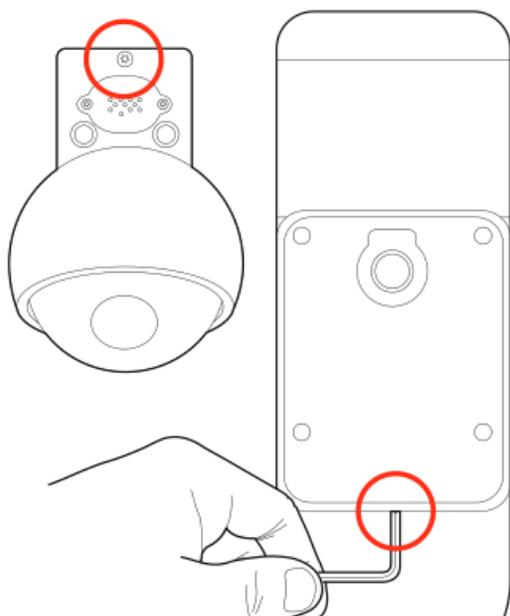
Le bornier de connexion se dévisse afin de libérer la caméra, dévissez les 2 vis pour ne conserver que l'embase pour plus de facilité durant l'installation.
