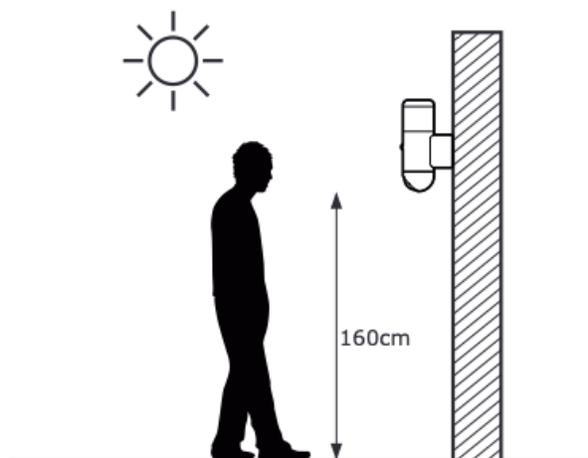
La caméra peut être installée en lieu et place d'un luminaire existant. Elle nécessite une connexion aux conducteurs de phase (L) neutre (N) et terre (conducteur de sécurité jaune/vert)
