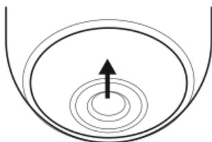
Bloquez le mouvement de la caméra à l'aide de l'encoche creusée puis dévissez les 2 vis permettant d'accéder au logement
