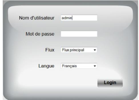
Sélectionnez la langue d'affichage puis entrez l'identifiant et le mot de passe de connexion à votre caméra. Par défaut l'identifiant est **admin** et le mot de passe est vierge, laissez la zone vide. Lors de votre première connexion, la caméra va aussitôt vous inviter à remplacer l'identifiant et le mot de passe par défaut pour plus de sécurité :
