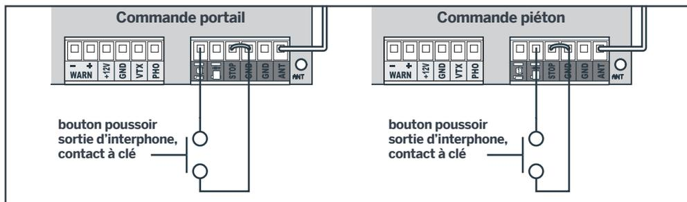
Il est possible d'utiliser plusieurs organes de commande filaires sur la même entrée, pour cela il faut les brancher en parallèle :
