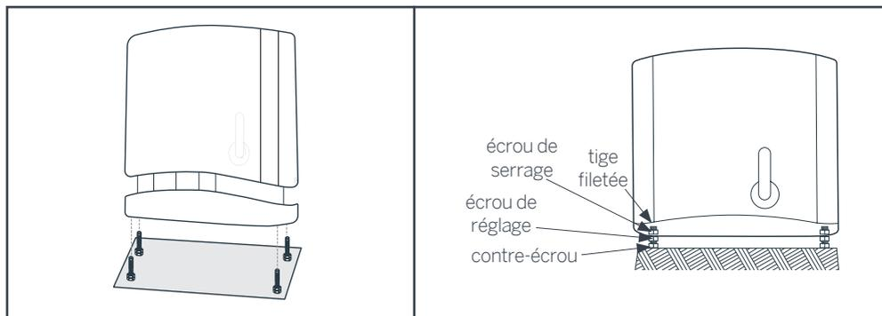
Lorsque le moteur est bien horizontal, serrez les contre-écrous pour bloquer l'écrou de serrage puis serrez les écrous de serrage pour maintenir le moteur en position.
