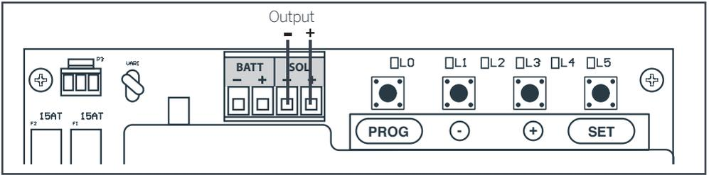
1. Connecter la motorisation au bornier « OUTPUT » en utilisant un câble 2 x 1,5 mm<sup>2</sup>, de longueur ne dépassant pas 2 m. Si la longueur de câble nécessaire au raccordement est supérieure à 2 m, utiliser du câble 2 x 2,5 mm<sup>2</sup> (maximum 5 m).
