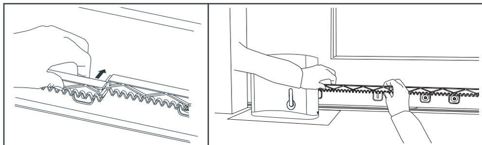
Vérifiez que la totalité de la crémaillère est centrée sur la roue dentée du moteur. Si ce n'est pas le cas, ajustez la position du moteur sur son socle.
