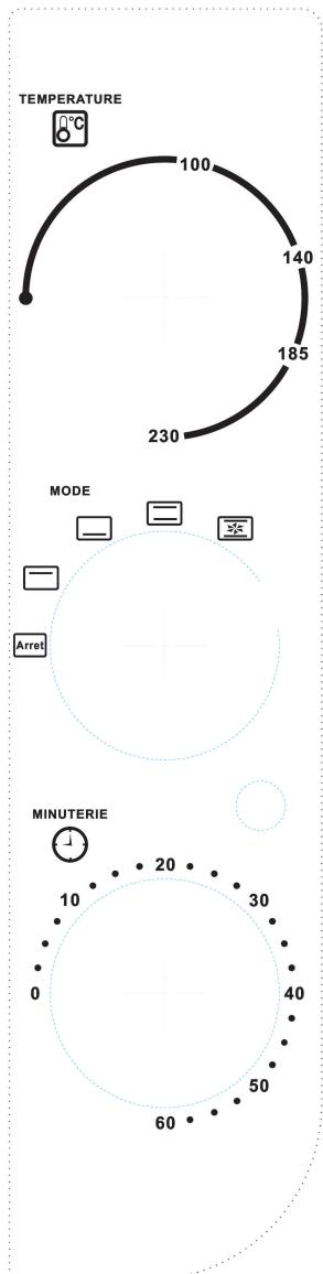
**Mando de la temperatura:** se puede seleccionar desde una temperatura hasta una temperatura de 230 °C. Se puede seleccionar la temperatura deseada en función de la cocción que vaya a realizar.
