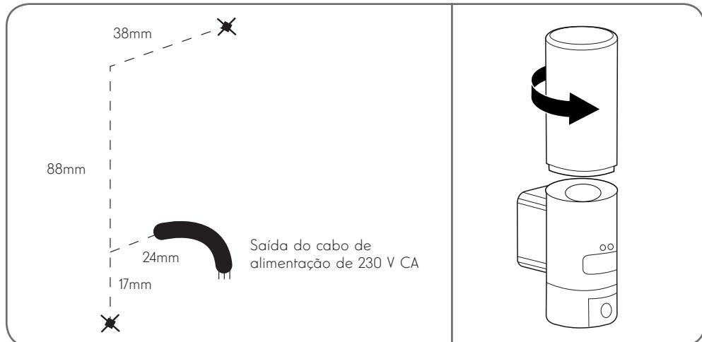
Desaparafuse os parafusos de acesso à base da câmara com a ajuda da chave sextavada fornecida para aceder ao terminal de ligação e às localizações dos parafusos de fixação na parede.
